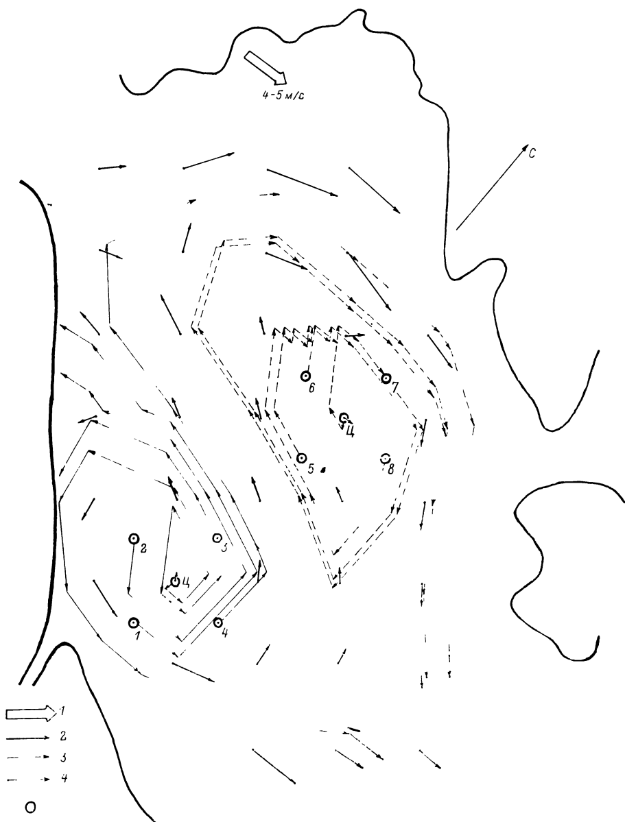
Рис. 51. Траектории перемещения единичных объемов воды в системе циклон — антициклон в западной части Рыбинского водохранилища.
